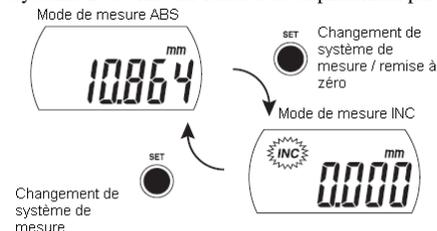
**REMARQUE** • Lors du changement de système de mesure de ABS à INC, l'affichage est réinitialisé.
