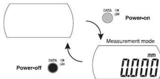
**REMARQUES :** Après la mise sous tension, l'instrument démarre toujours en mode Mesure.
