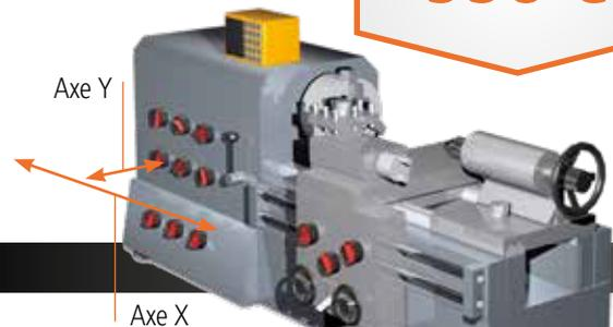
COMPTEUR 2 axes KA-200 + deux règles avec capacité cumulée max de 2 000 mm
