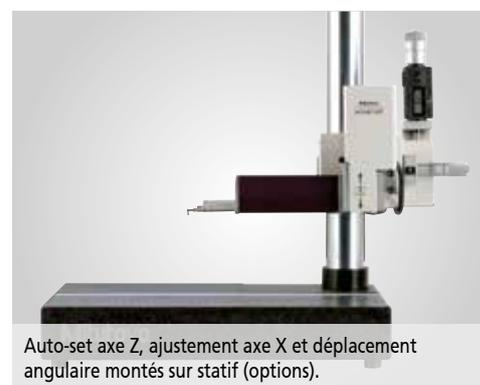
Auto-set axe Z, ajustement axe X et déplacement angulaire montés sur statif (options).
