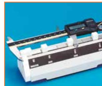
Vérification de la précision d'un pied à coulisse (mesure extérieure)
