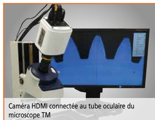
Caméra HDMI connectée au tube oculaire du microscope TM
