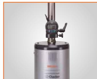
Étalonnage utilisant un comparateur Digimatic
