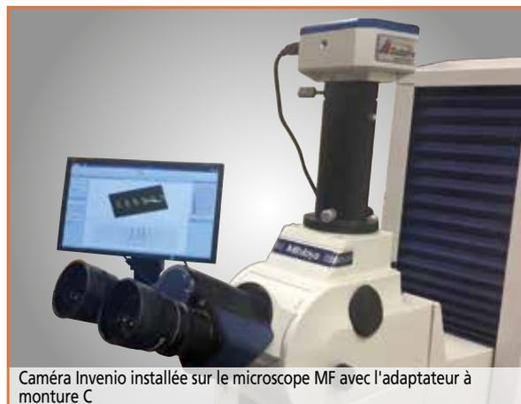
Caméra Invenio installée sur le microscope MF avec l'adaptateur à monture C
