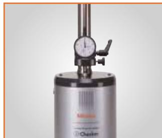
Étalonnage utilisant un comparateur de type analogique
