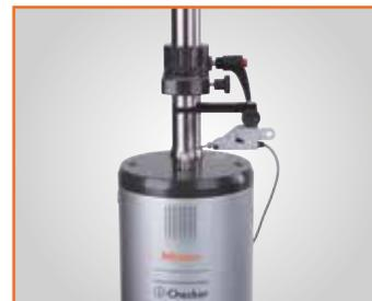
Contrôle à l'aide d'un comparateur à palpeur orientable (palpeur inductif)
