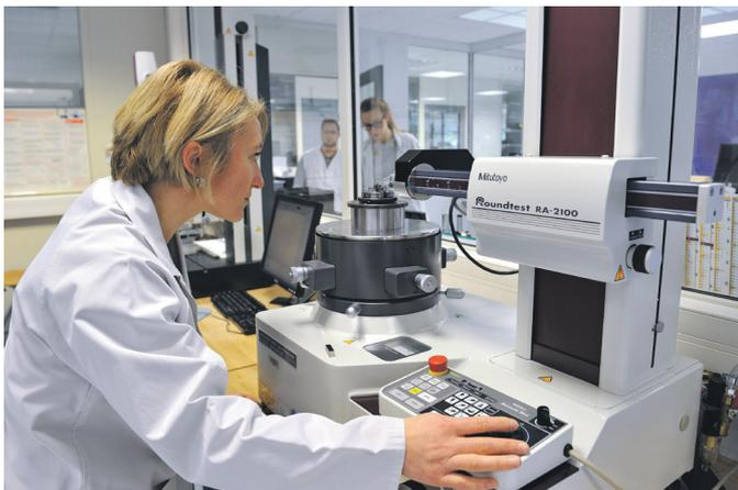
Machine de mesure d'écarts de forme MITUTOYO : Roundtest RA 2100 CNC.
