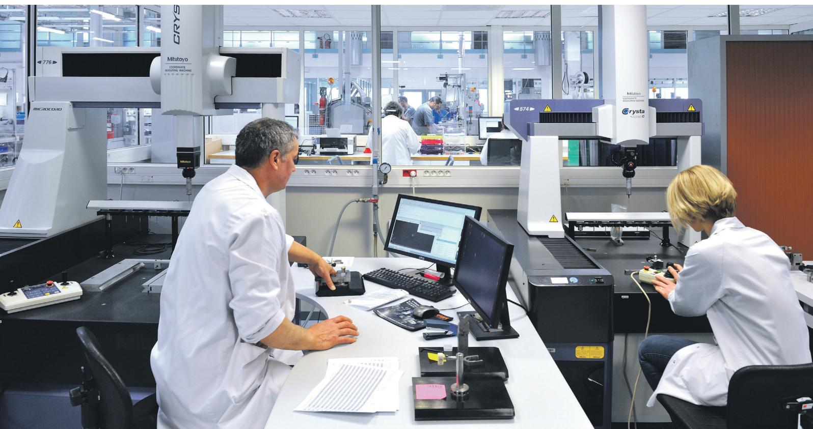
Machines de mesure tridimensionnelle CNC MITUTOYO : Crysta-Apex S.
